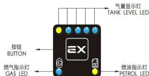
① Como se muestra en la imagen de la derecha P3.2, cuando estas dos luces amarillas se encienden, significa que el sistema está en modo gasolina, que siempre está en modo gasolina y no se convertirá al modo gasolina.
