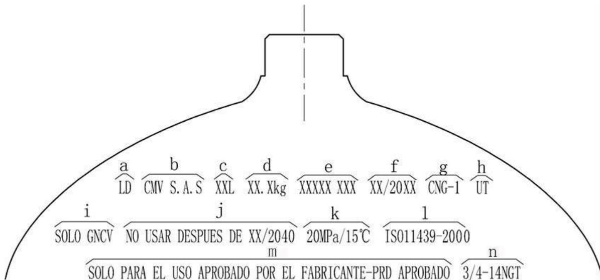
a. Fabricante LD = Anhui, b.-Importador / Comercializador, c.-Capacidad en Litros, d.-Peso del cilindro, e.-Serial del cilindro, f.-Fecha de fabricación, g.- Cilindro tipo uno CNG-1, h . Marca de revisión ultrasónica UT, i.- Sol o par a uso de GNV J. Vida útil, k- Presión de trabajo, normalmente 20 Mpa/15°C, l.- ISO standard m. Cilindro tipo uno CNG-1, n.- Rosca ¾ NGT
