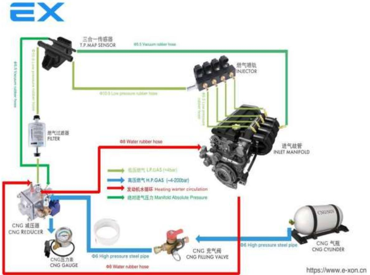
Diagrama esquemático de funcionamiento de las piezas mecánicas de GLP
